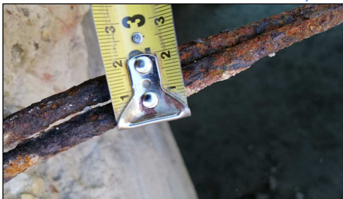
18-22. Ábra: Rossz minőségben készült Bohn födémrendszer 23. és 24. Ábra: Korrodált betonacélok toldás helyén
